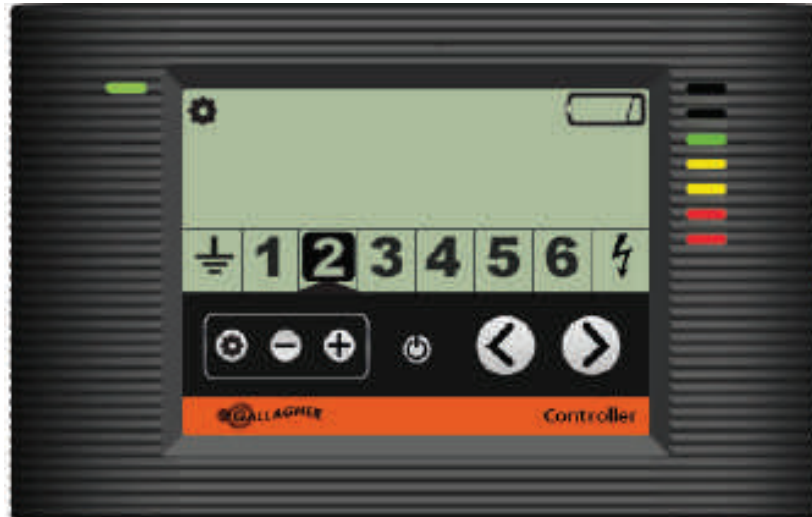
Kontroll visar zon 2 med en låg batterinivå
