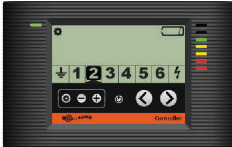
Kontroll visar zon 2 med en låg batterinivå
