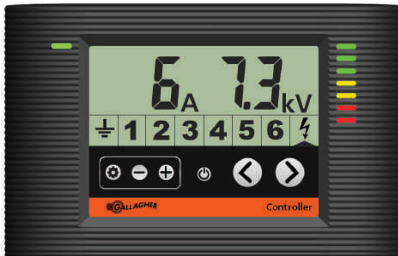
Kontrollenheten visar att aggregatet fungerar normalt
