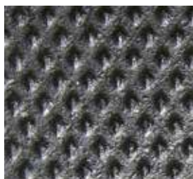
yta: greppfast och formbar diamantprofil
