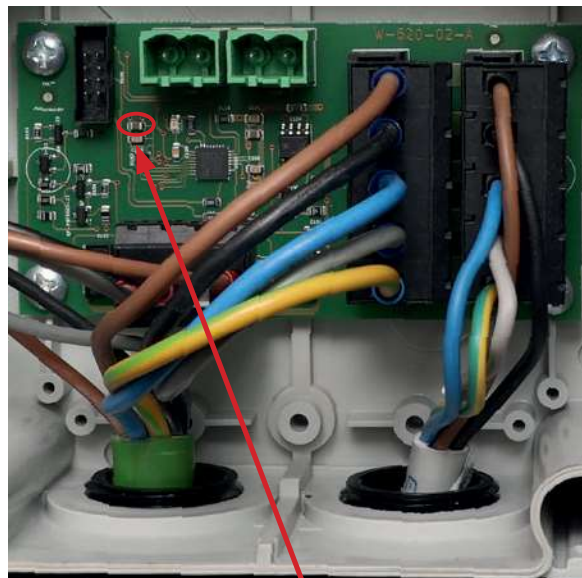
Bild 11: Sensorns kretskort LED
